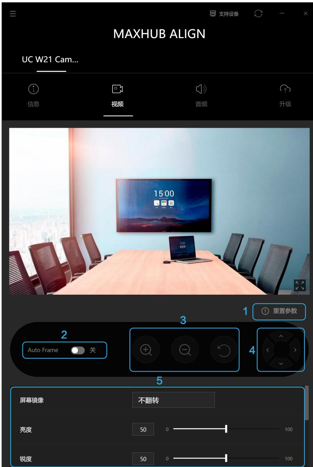
注意:对于支持自动分帧的UC设备, 请关闭自动分帧功能, 以便使用数字变焦和数字平移/倾斜功能。
