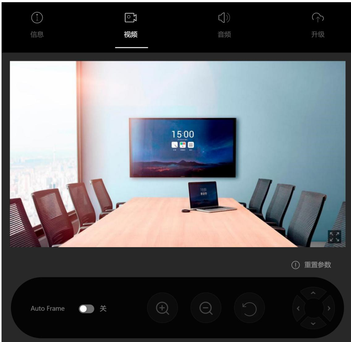
数码平移/倾斜只有数字变焦放大后才能进行操作，可以点击[上/下/左/右]来移动变焦的相机视图。如果摄像头的视场角是最宽的，导航板将变灰。
